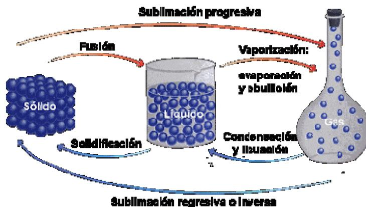
*Ejemplos: Eliminación de agua en una meladura para obtener azúcar; eliminación de un solvente orgánico para obtener un sólido cristalino; disminución de un volumen de líquido concentrando así un sólido disuelto o llevándolo inclusive hasta el secado. Sustancias como el alcohol, la acetona, la gasolina, etc., en contacto con el medio ambiente experimentan una vaporización sin que se les suministre calor, el fenómeno ocurre debido a la baja presión existente sobre ellas.*
